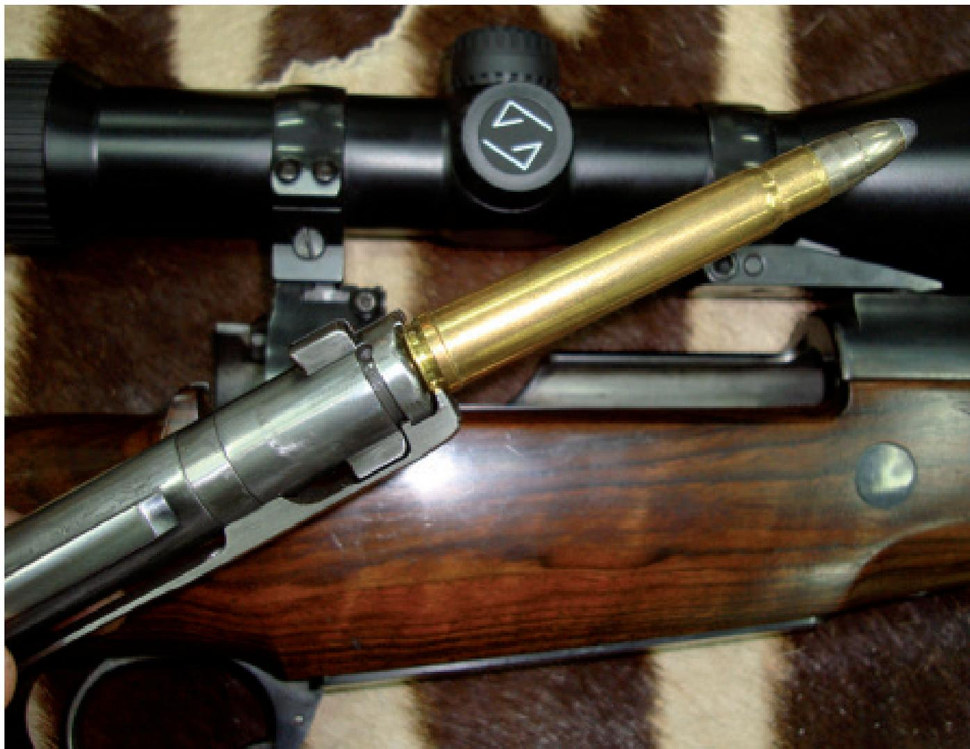
Detalle de los dos grandes tetones del cerrojo que lo sujetan al recámara a prueba de todo tipo de presiones. También vemos los agujeros que permitirían una salida de gases hacia abajo alejados de la cara del tirador, en caso de tener una perforación del casquillo.
